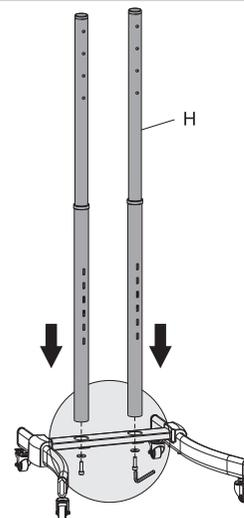
Anexe as colunas na base utilizando os parafusos e arruelas apropriadas. Aperte os parafusos utilizando a chave allen.
