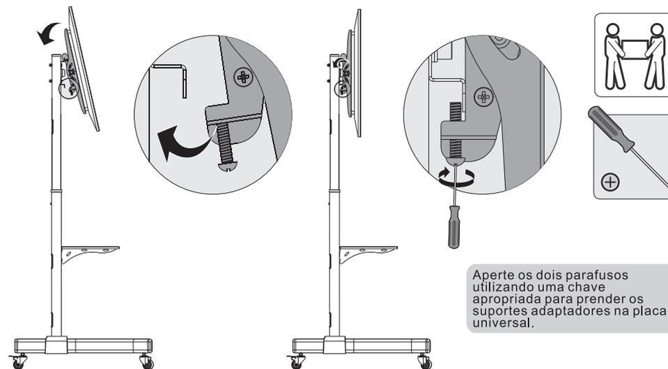
Aperte os dois parafusos utilizando uma chave apropriada para prender os suportes adaptadores na placa universal.
