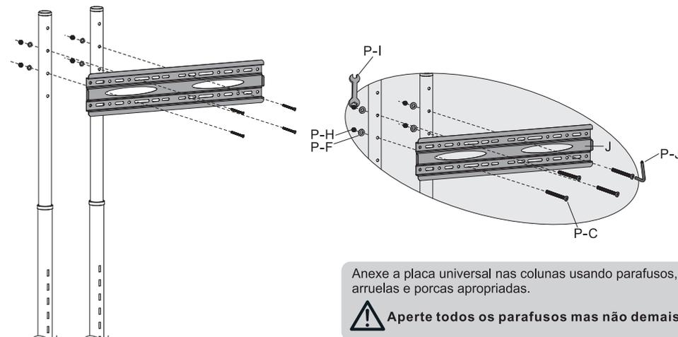
Anexe a placa universal nas colunas usando parafusos, arruelas e porcas apropriadas.
